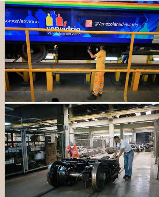
que se paralicen las flotas de las diferentes líneas. Ellos han solucionado la corrección de rieles con el corazón en las manos, repotenciando los motores de tracción y lo restablecen cuando su vida útil llega a su fin, cambian micas, luces y rodamientos, motores eléctricos, bobinas, repuestos mecánicos, correas, peldaños, empaaduras y conductores eléctricos, están entre la gama de piezas que ahora tienen la oportunidad de fabricar manos venezolanas para el sistema Metro de Caracas.
